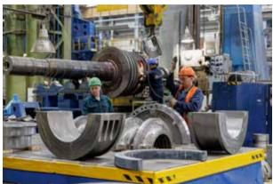
давления турбины Т-100 для ПАО «Т-Плюс». Согласно решению ремонтной комиссии выполнены работы по подготовке и контролю ремонтных диафрагм турбины Т-100 ПАО «Т-Плюс».
